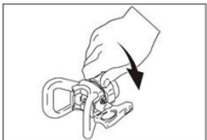
3. Поверните сборку и затяните ее, закрепив на распылителе
