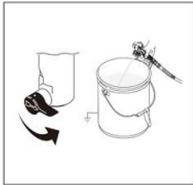
11. Закройте предохранительный клапан.
