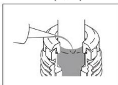
6. Заполните уплотнительную гайку горловины смазкой, чтобы предотвратить преждевременный износ уплотнения. Делайте это перед каждым распылением.
