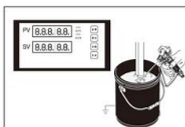
2. Установите давление на минимальное значение. Нажмите на спусковой механизм распылителя и удерживайте, чтобы сбросить давление
