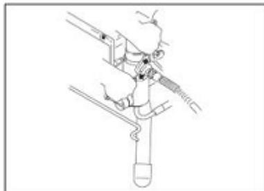
1. Подсоедините один конец газового шланга к распылителю и плотно затяните
